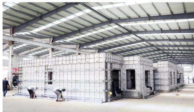
板系统的每个构件使用二维码管理，通过云计算大数据处理系统对每一块铝模板进行全程跟踪。采用机器人智能焊接生产线、全自动智能化流水线进行生产，实现了建筑专业能力和FM-BIM能力以及装配式能力三维一体研
