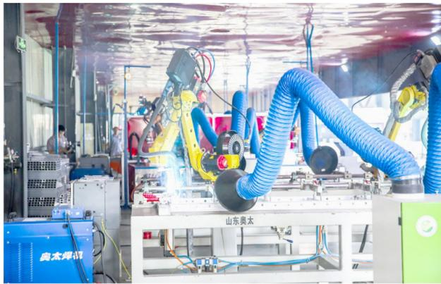
焊接机器人精准作业。
