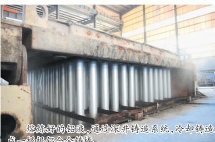
熔炼好的铝液,通过深井铸造系统,冷却铸造成一根根铝合金铸棒。
