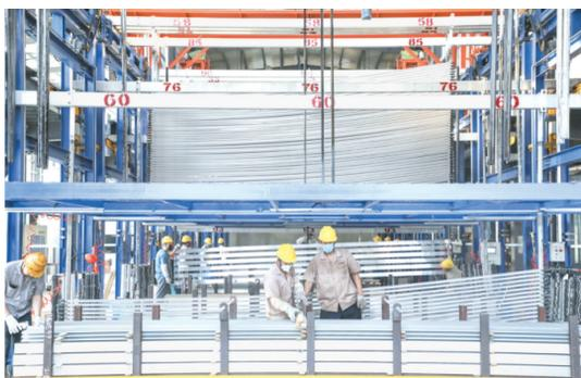
位于滨州经济技术开发区的华建铝业科技有限公司年产20万吨高端铝合金型材生产加工项目。该项目充分利用当地铝资源优势和华建铝业铝型材深加工和市场开发优势，采用先进的挤压在线淬火、时温控制和三涂层工艺，拥有国家专利200多项，产品较同行业力学性能提高20%、成型性能提高15%，应用范围从建筑领域向高精尖领域拓展延伸，被应用于国家博物馆等众多国内外知名工程。
