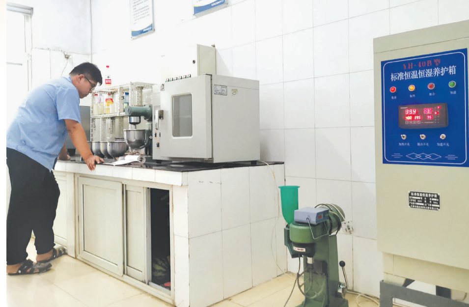
对进场水泥进行各项指标检测,严把质量关。
