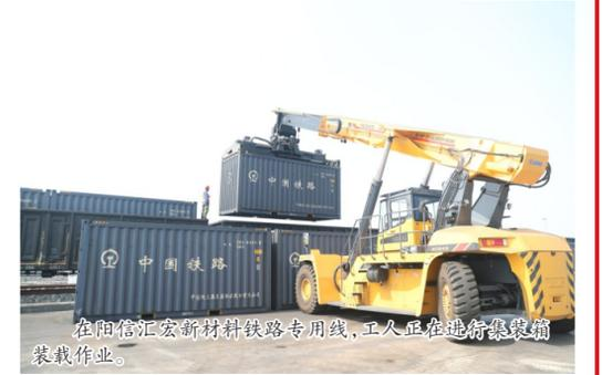
在阳信汇宏新材料铁路专用线,工人正在进行集装箱装载作业。
