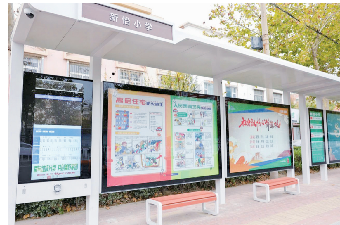
为提升助学公交的整体服务质量,此次升级改造中,在新怡小学站候车亭安装了2块嵌入式电子站牌。这些站牌将为学生和家长提供实时、准确的车辆到站信息,使其能够更加便捷地规划行程,确保顺利出行。
