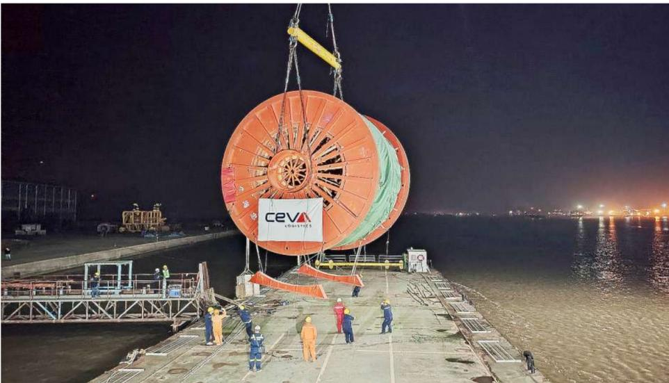
近日，由无棣海忠软管制造有限公司自主设计制造的1.1公里9.5英寸海底混输软管在无棣县东风港经济园区泰尔河西岸码头装船。
