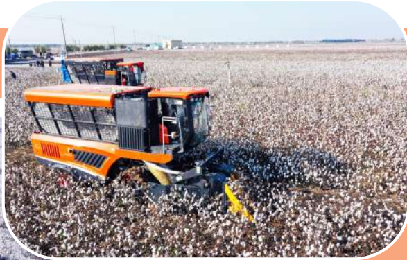
近日,全省棉花产业高质量发展推进会在无棣县召开。会议期间,与会人员到无棣县西小王镇5000亩机采棉示范现场进行观摩。该基地已连续多年推广应用机采棉技术,今年首次引进铁建重工、南京农业机械化工厂、天鹤棉机等不同厂家、不同型号的中小型采棉机。现场演示中,采棉机快速将棉花从棉秆上脱离,机采率达到100%,采净率高达95%以上。(通讯员 杨景成 摄影)
