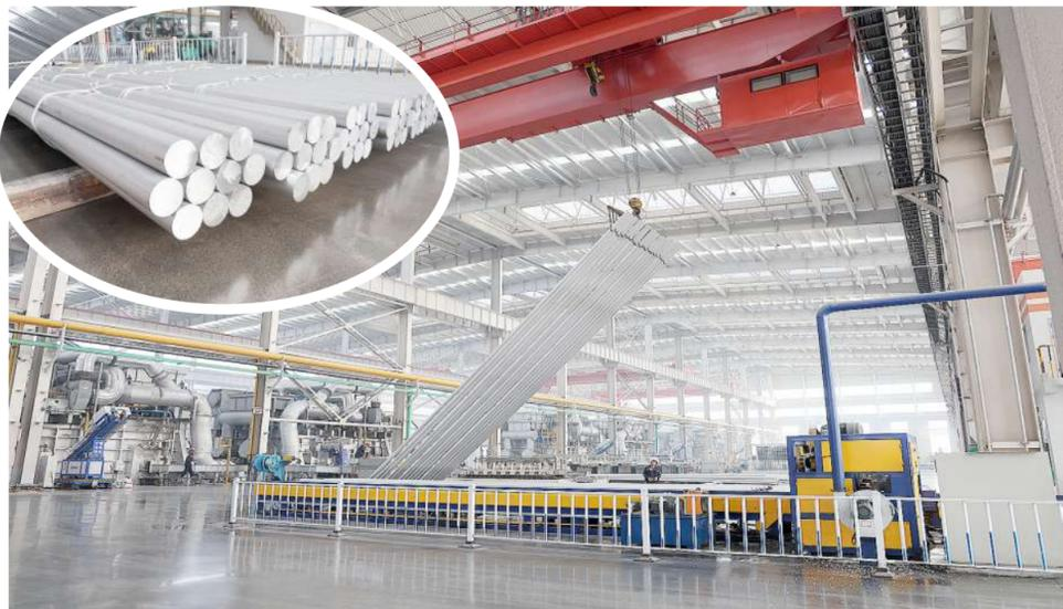
走进生产车间,记者看到,一座座巨大的倾动炉依次排列,工人师傅正在操作巨型吊机,将“新鲜出炉”的一排排细长的银色铝棒吊运至产品区摆放整齐,生产场景十分壮观。“我们以收购的废铝为原材料,通过前处理车间进行自动化筛选、分类、处理后,在合金化车间融化重铸,并按照一定比例添加各种微量元素,产出高品质铝合金棒材、扁锭等产品。”项目负责人介绍,“与传统铝棒、铝锭相比,这些产品化学成分更加均匀,从应用于建筑铝型材、太阳能边框等低端领域,一举提升至汽车轻量化、3C电子配件等高端领域。”
