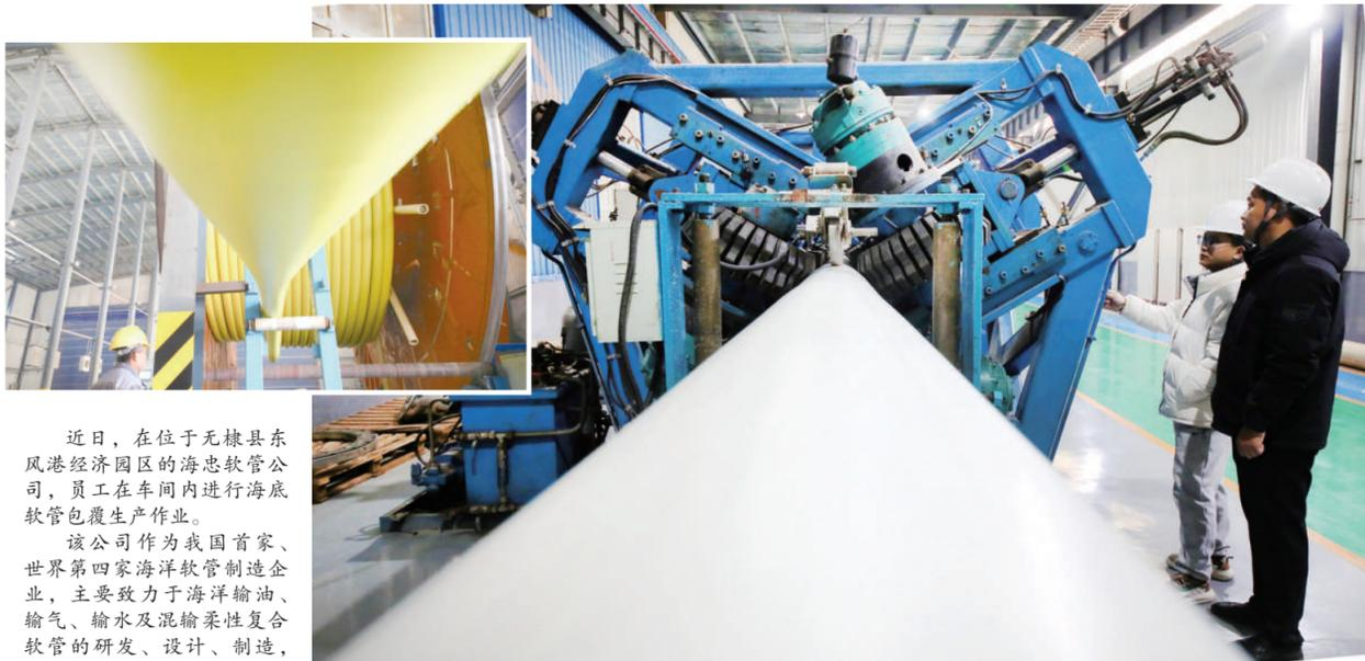
近日,在位于无棣县东风港经济园区的海忠软管公司,员工在车间内进行海底软管包覆生产作业。
