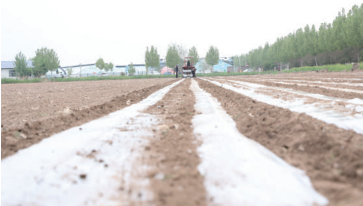
北斗导航精准播种履带机完成无人驾驶精准覆膜。
