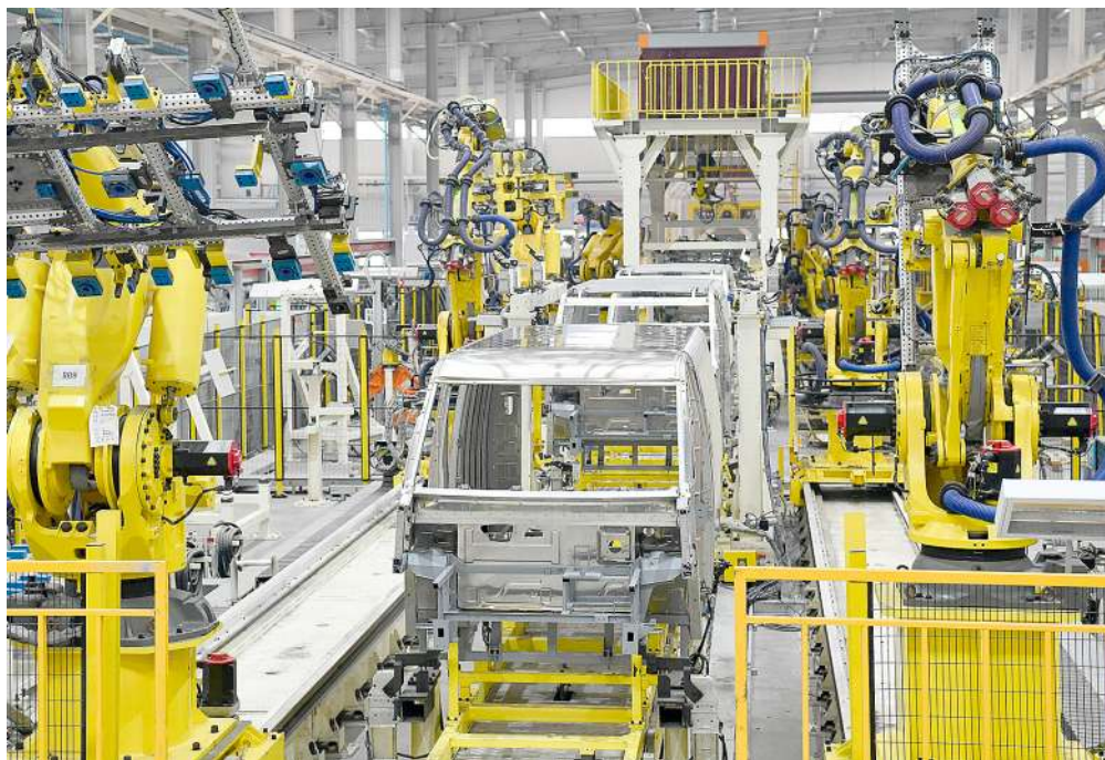
魏桥轻量化基地全铝车身集成生产线，机器人正在铆接全铝小物流车身。
