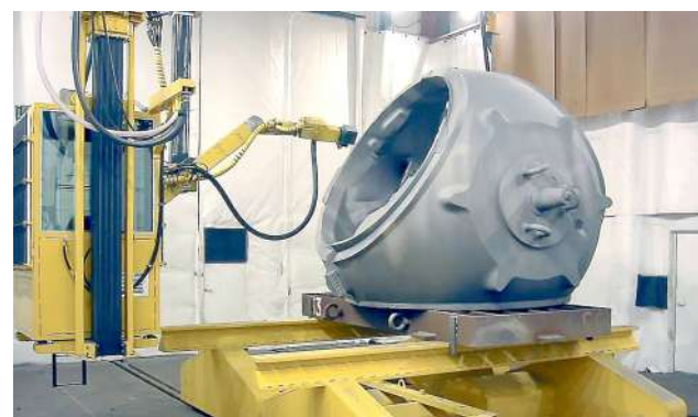
开泰抛丸机械股份有限公司清理机器人正在对新能源风电轮毂表面清理。
