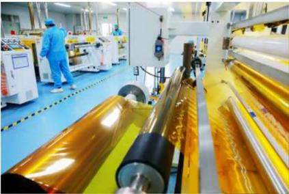
1月18日,在沾化经济开发区欧亚化工有限公司PI膜分切车间,工作人员操作机器生产被称为“黄金薄膜”的聚酰亚胺薄膜产品。
