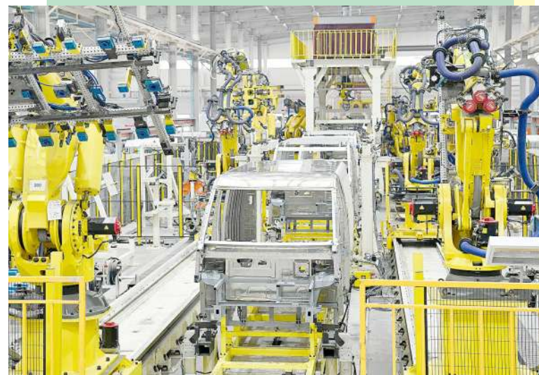
魏桥轻量化基地全铝车身集成生产线,机器人在铆接全铝小物流车身。(董乃德 摄影)
