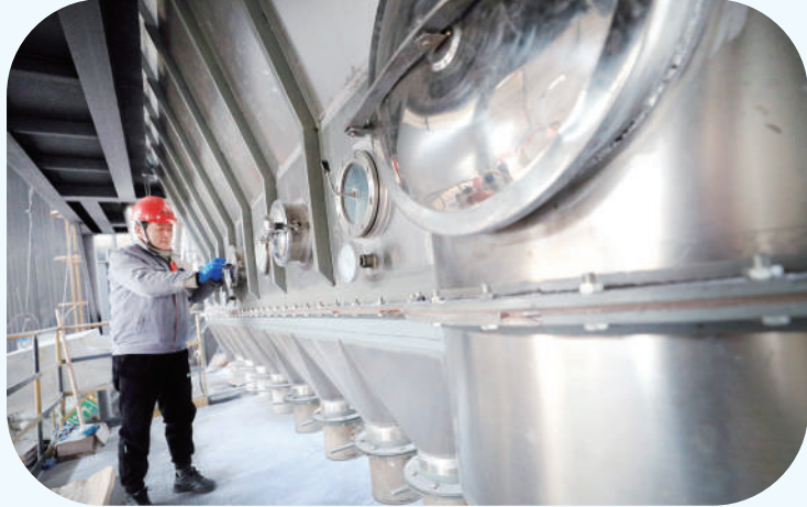
在无棣宜能化工有限公司2万吨锰酸锂项目车间内,工人对对苯二酚进行烘干、脱水。
